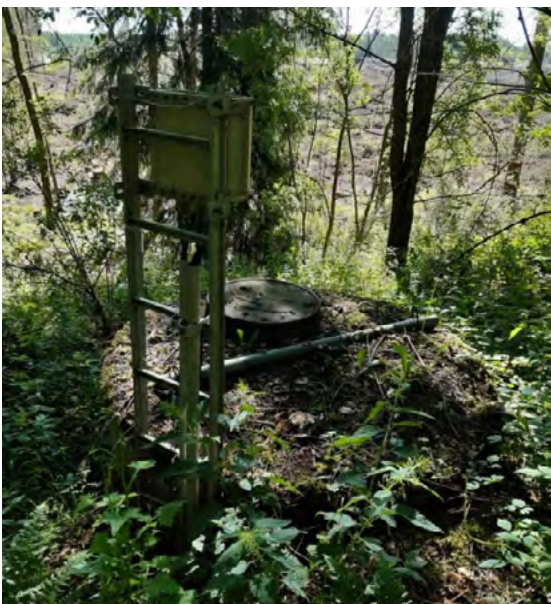
Рисунок 68. Точка забора грунтовых вод на полигоне Саммалсуо.
